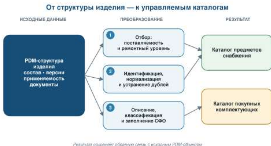
Рис. 1. Преобразование структуры изделия в каталожные представления.
