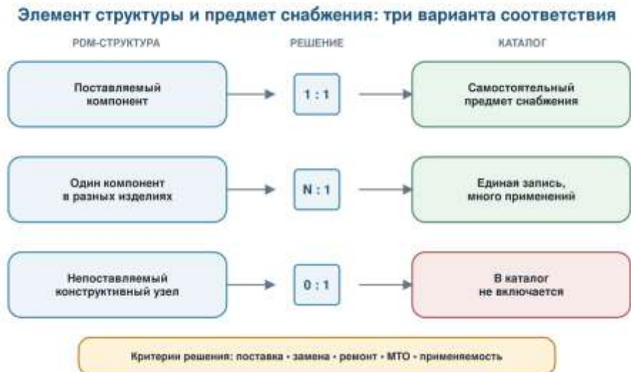
Рис. 2. Варианты соответствия элемента структуры изделия и предмета снабжения.
