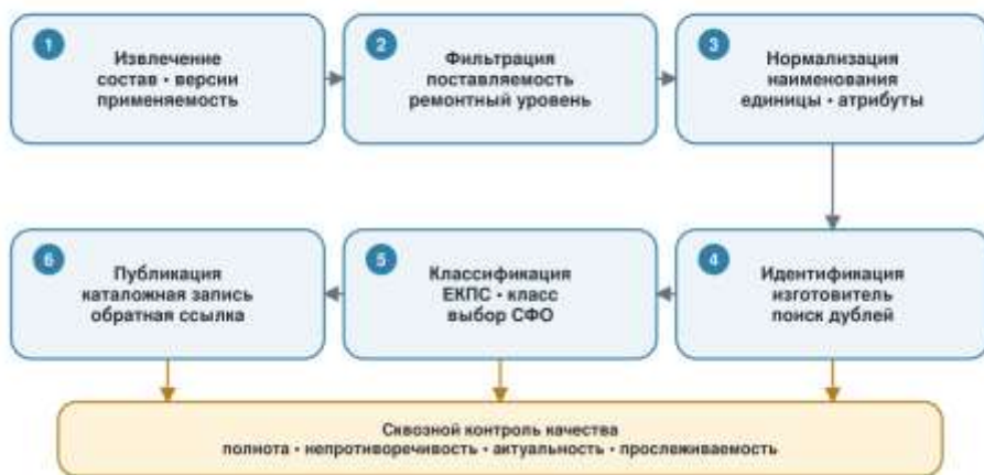
Рис. 3. Технологический процесс каталогизации на основе данных PDM.
