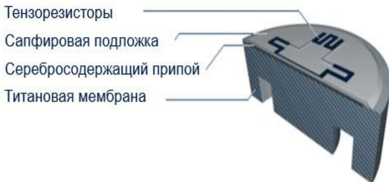
Рис. 3. Схема тензорезистивного датчика давления.
