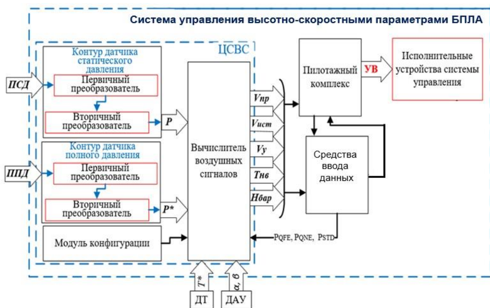
Рис. 1. Функциональная схема системы управления аэродинамическими параметрами БПЛА: P_{ст} – статическое давление; P_n – полное давление; T – температура заторможенного потока; \alpha, \beta – аэродинамические углы; V_{пр} – приборная скорость; V_{ист} – истинная скорость; V_y – вертикальная скорость; H_{бар} – барометрическая высота; ПВД – приемник статического давления; ППД – приемник полного давления; ДТ – датчик температуры; ДАУ – датчик аэродинамических углов; ЦВС – цифровая система воздушных сигналов; УВ – управляющее воздействие.
