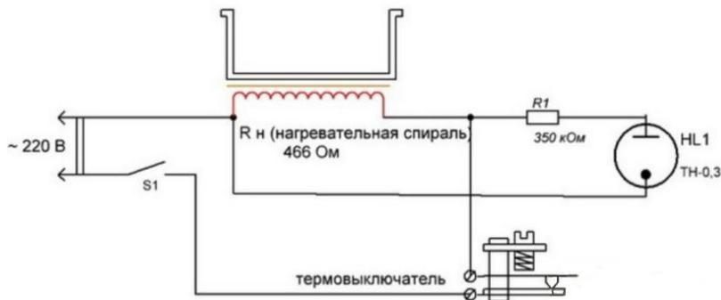
Рис. 1. Принципиальная электрическая схема небулайзера.
