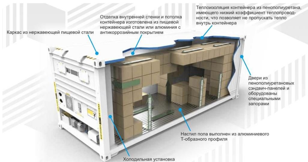
Рис. 2. Составные элементы рефрижераторного контейнера [3].
