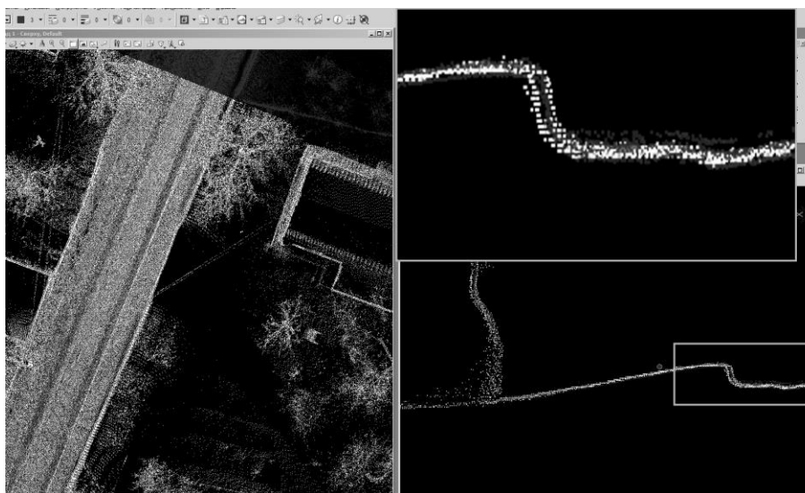
Рис 5. Результат сведения в RiProcess (темные точки) по сравнению с результатами сведения точек лазерных отражений в TerraMatch (белый)
