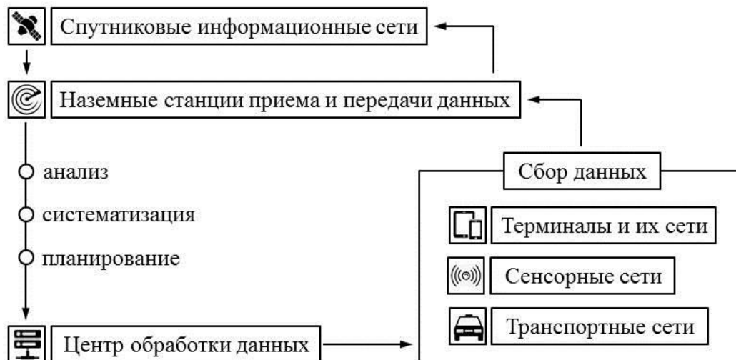
Рис. 2. Базовый алгоритм использования наземных станций в рамках S-IoT
