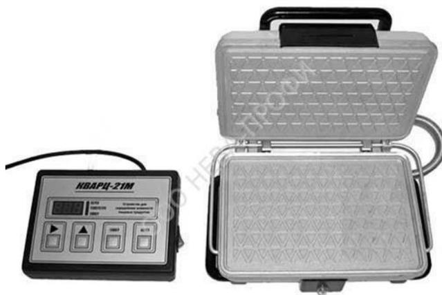
Рис. 3. Прибор ВЧМ (прибор Чижовой)
