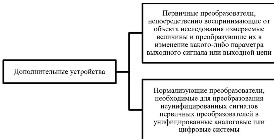
Рис. 1. Дополнительные устройства ИИС
