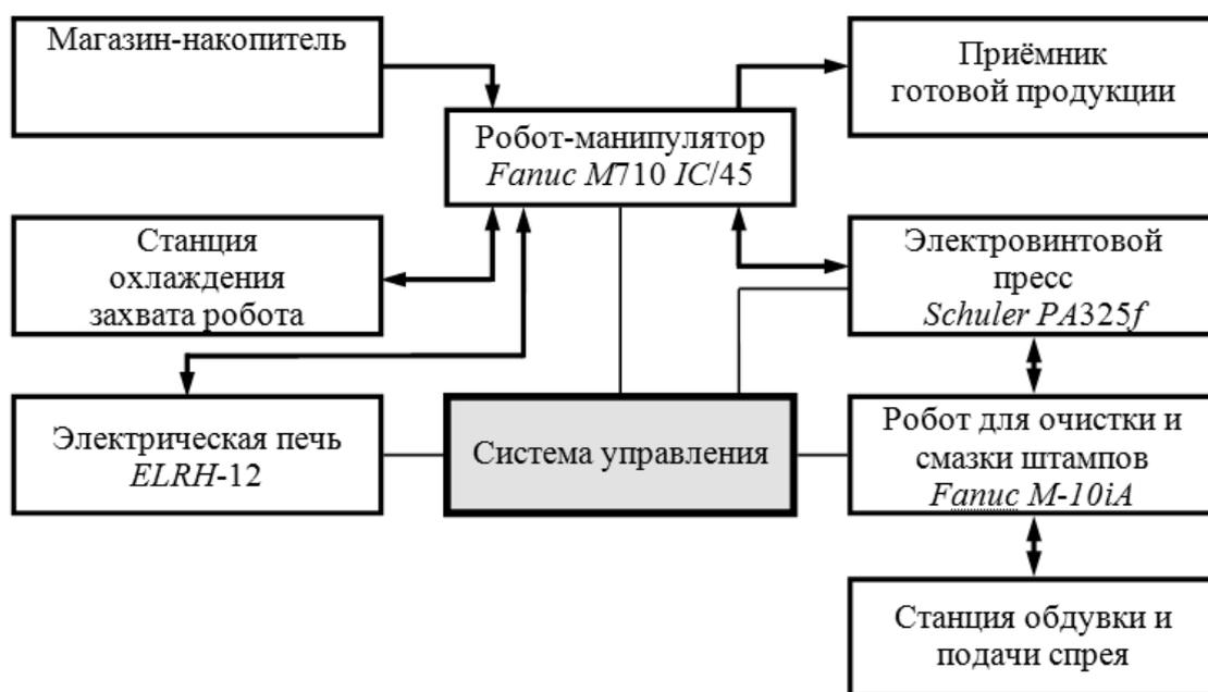
Рис. 1. Принципиальная схема разработанного РТК
