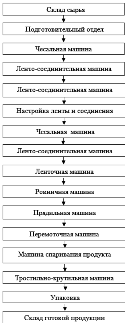
Рис. 3. Технологическая цепочка производства пряжи
