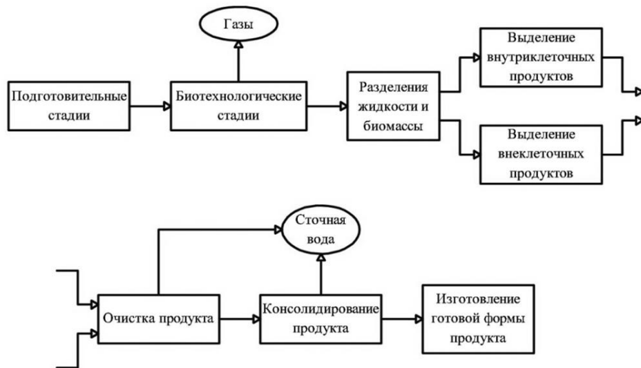
Рис. 1. Принципиальная функциональная схема технологии производства кормовых продуктов
