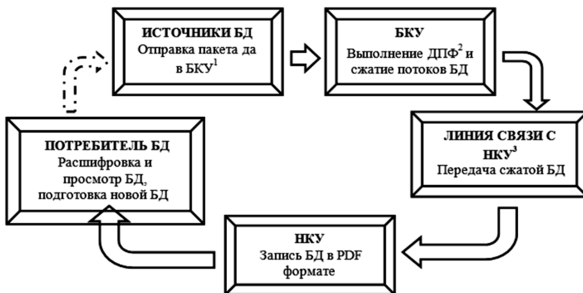
Рис. 1. Схема сжатия телеметрической базы данных (БД) для бортовых комплексов управления 1. БКУ – Бортовой комплекс управления; 2. Дискретное преобразование Фурье; 3. НКУ – Наземный комплекс управления)
