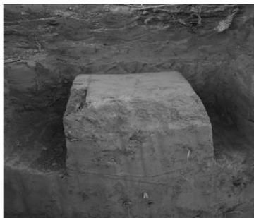
*а) место среза монолита из шурфа*
