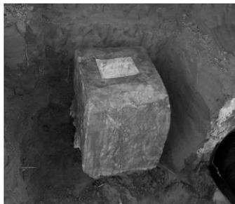
*б) вырезанный монолит из шурфа (ненарушенная структура)*
