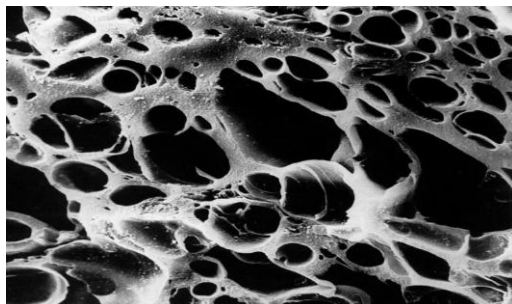
Рис. 6. Структура пор активированного угля
