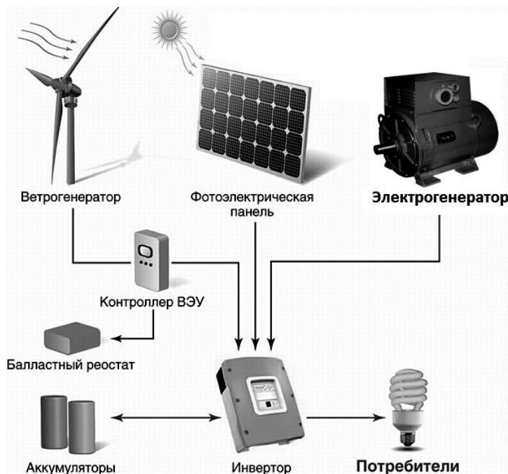
Рис. 5. Вариант системы электроснабжения
