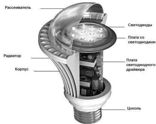
Рис. 1. Структура светодиодной лампы
