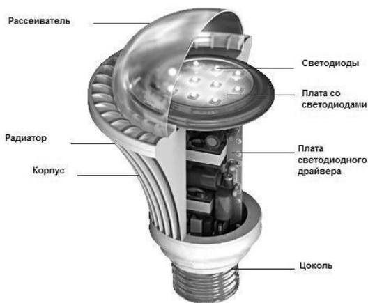
Рис. 1. Структура светодиодной лампы
