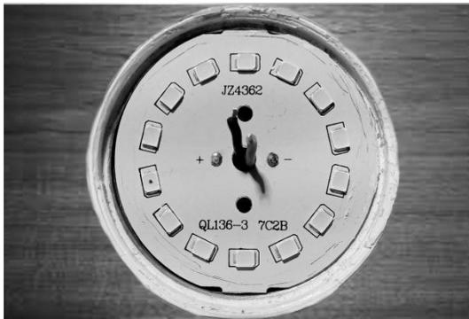
Рис. 3. Плата со светодиодами
