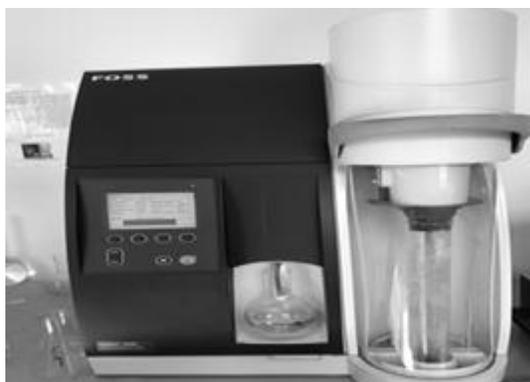
*Рис. 2. Аппарат перегонки (дистилляции)*
