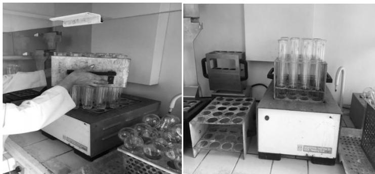
*Рис. 1. Размещение колб Келдала в аппарат сжигания (digestion)*
