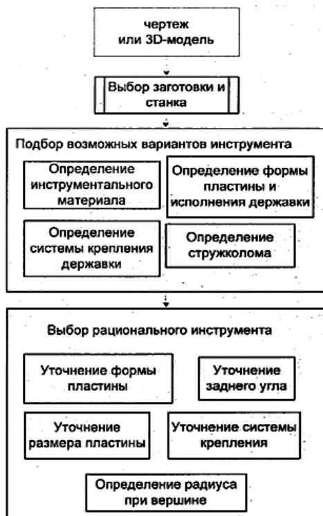
Рис. 1. Общая схема выбора режущего инструмента на примере подбора токарного резца
