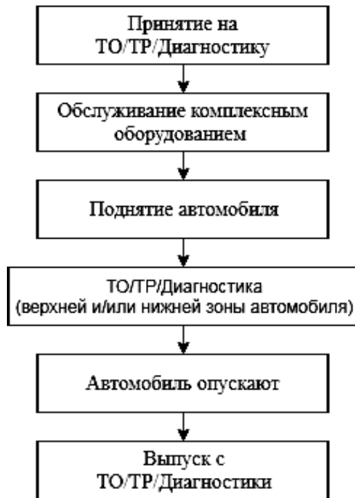
Рис. 5. Схема технологического процесса с конструкцией
