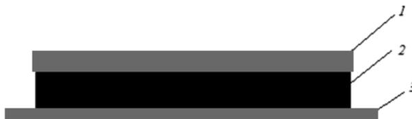
Рис. 2. Схема резинометаллической опоры
