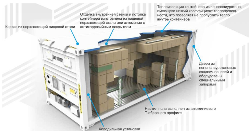
Рис. 2. Составные элементы рефрижераторного контейнера [3].
