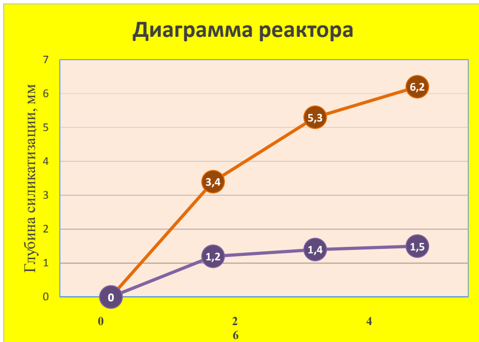
Диаграмма 1. Результаты силикатизации за 2,4 и 6 суток: кривая зеленого цвета – система с жидким стеклом, желтого – с туфом.
