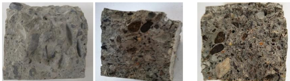
Рис. 2. Излом силикатизированных образцов № 2.
