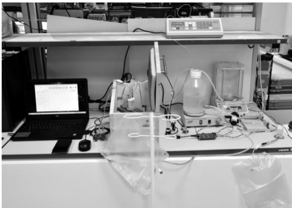
Рис. 2. Общий вид системы контроля технических характеристик аппарата «искусственная поджелудочная железа»
