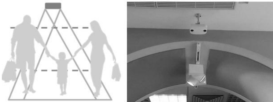
Рис. 5. Подсистема контроля трафика посетителей на основе 3D-видеосчетчиков
