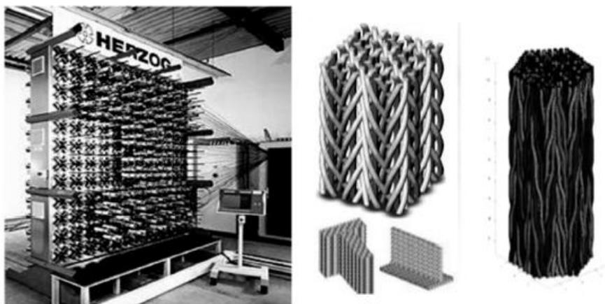
Рис. 6. 3Д плетельная машина и производимые на ней структуры
