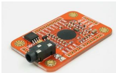
Рис. 1. Плата распознавания VRM v3.1
