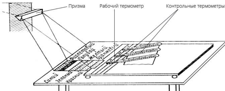
Рис. 1. Схема проведения опыта Гершеля
