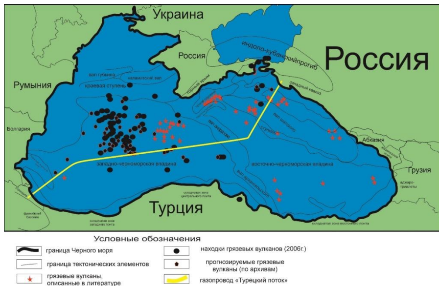
Рис. 1. Схема расположения газопровода «Турецкий поток» в Черном море с нанесенными тектоническими элементами и грязевыми вулканами. (Составитель: Ильченко А.А., CorelDRAW, 2020 г.)
