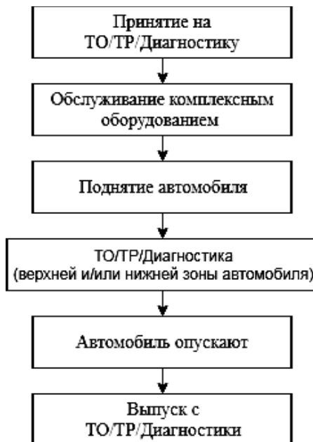
Рис. 5. Схема технологического процесса с конструкцией
