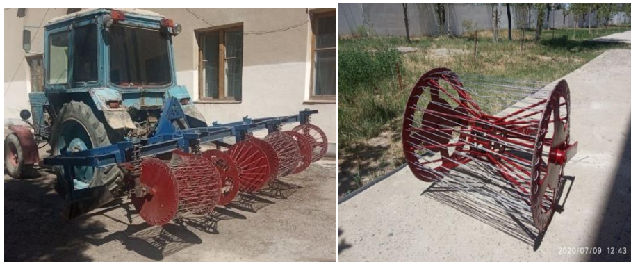
Рис.1. Разработанный гребнегрядоделатель с катком-гребнеобразователя
