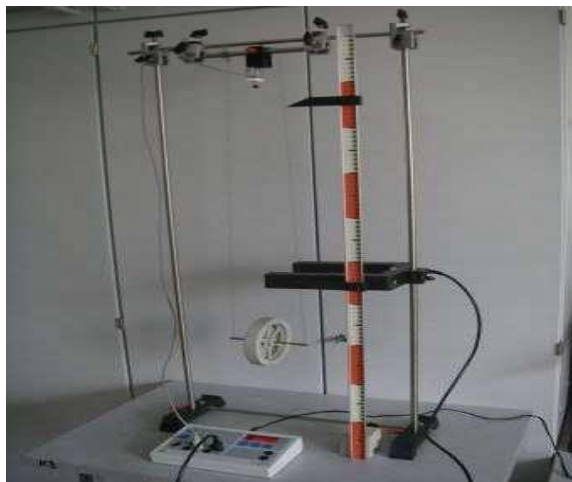
Рис. 2. Колесо в стартовом положении помощью колеса Максвелла
