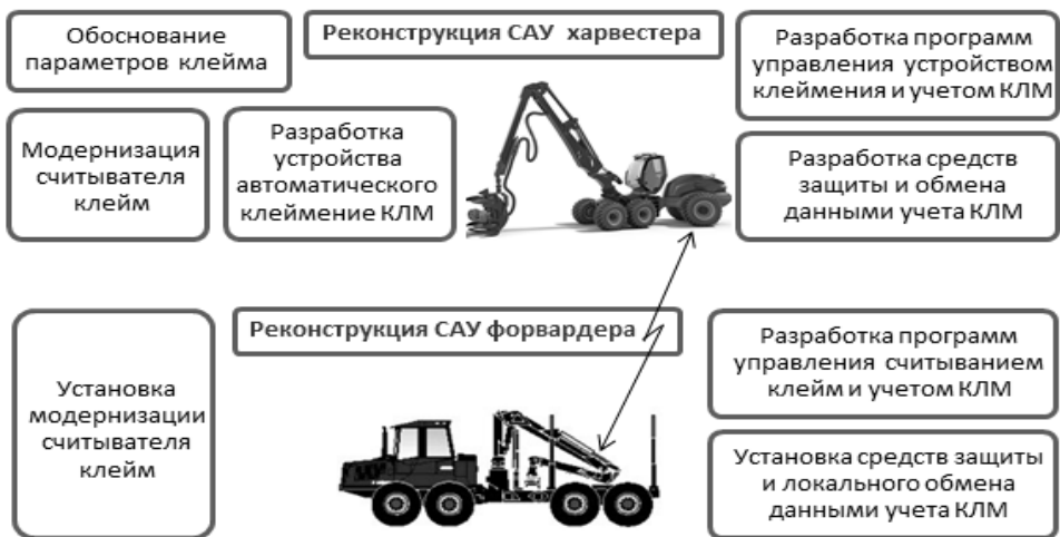
Рис. 1. Структура управления потоком КЛМ на лесосеке
