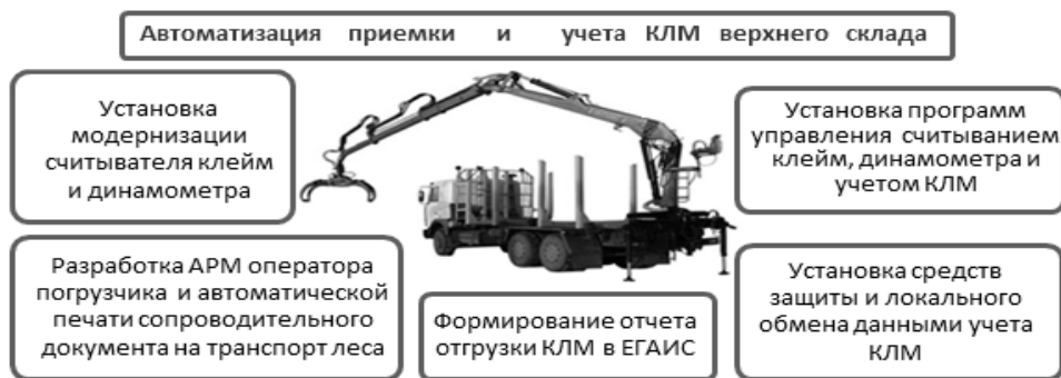
Рис. 2. Схема организация автоматического управления потоком КЛМ, подлежащих вывозке с лесосеки
