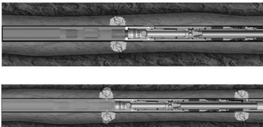
Рис. 2. Технология многостадийного гидроразрыва пласта Coil-jet
